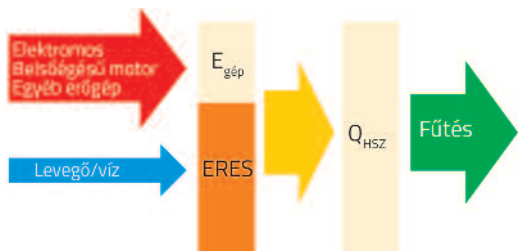
2. ábra – A levegős hőszivattyú energifolyamának ábrája
