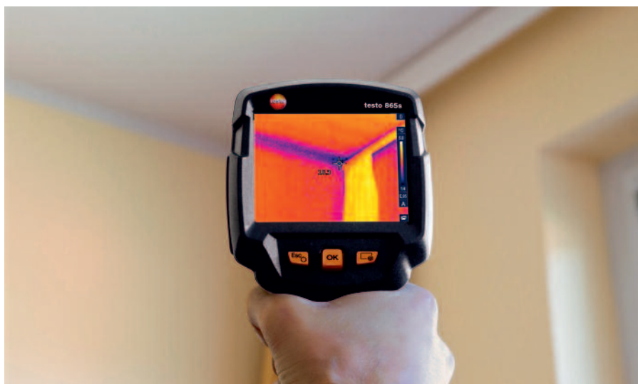
testo-865s – Penészedésre hajlamos sarkok feltérképezése
