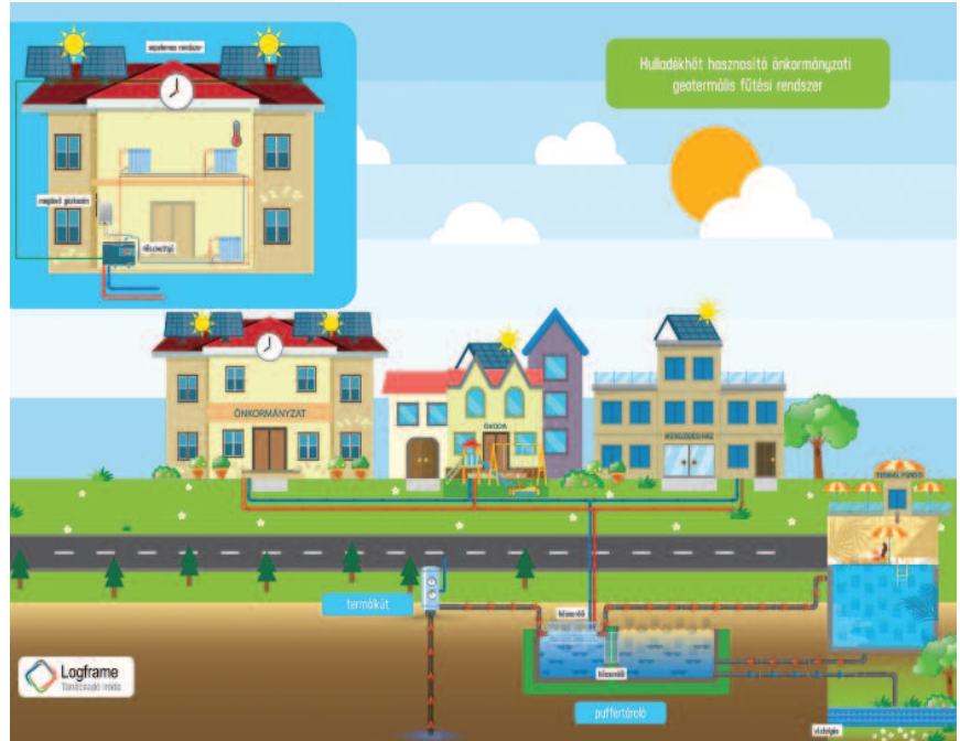
1. ábra – Geotermális hulladékhővíz típusú hőszivattyús fűtési rendszer
