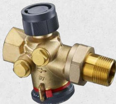
Druckunabhängiges Regelventil für den dynamischen hydraulischen Abgleich von Wärmetauschern, zum Beispiel Gebläsekonvektoren oder Kühldecken und Verteilleitungen in Heizungs- und Kühlanlagen mit geschlossenen Kreisläufen. Die Ventilkombination besteht aus einem automatisch arbeitenden Mengenregler und einem Regelventil und kann mit einem Stellantrieb oder einem Handregulierkopf ausgestattet werden. Einbau im Vor- oder Rücklauf.
