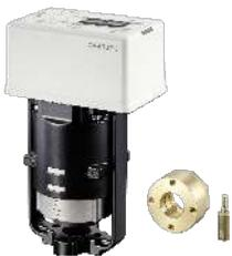
**Aktor M Ansteuerung stetig mit 0(2) - 10 V bzw. 0(4) - 20 mA oder 2-Punkt-/ 3-Punkt-Regelung, Klemmverbindung**
