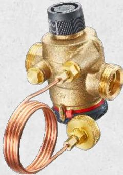
Differenzdruckregler mit Durchflussbegrenzung und Zonenregelung für den Einbau in Zentralheizungs- und Kühlanlagen. Die Ventilkombination kann mit einem Stellantrieb oder einem Handregulierkopf ausgestattet werden. Zusätzlich wird der maximale Differenzdruck über die Regelzone beschränkt. Einbau nur im Rücklauf.
