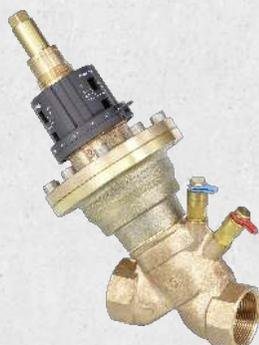
Druckunabhängiges Regelventil für den dynamischen hydraulischen Abgleich von Wärmetauschern, zum Beispiel Gebläsekonvektoren oder Klimageräten, und Verteilleitungen in Heizungs- und Kühlanlagen mit geschlossenen Kreisläufen. Die Ventilkombination, besteht aus einem automatisch arbeitenden Mengenregler und einem Regelventil und kann mit einem Stellantrieb ausgestattet werden. Einbau im Vor- oder Rücklauf.
