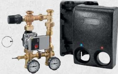
Für die Anbindung eines Feststoffkessels. Die Rücklauf­temperatur zum Feststoffkessel liegt min. bei ca. 55 °C und somit oberhalb des Taupunktes. Sie verhindert die Kondensat-Teer­bildung. Im Anfahr­betrieb läuft der Kessel­kreis im Kurzschluss. Über den Bypass wird dem Rücklauf heißes Vorlaufwasser zugeführt. Nach Erreichen der Rücklauf­temperatur von 55 °C öffnet das Mischventil.
