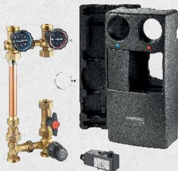
Für die Anbindung eines thermisch geregelten Heizkreises. Die Stationen dienen der Vorlauf-temperaturregelung und -begrenzung in kombinierten Radiator-Flächenheizungen. Sie beinhalten alle Armaturen, die für die Verbindung von Wärmeerzeuger, Pumpen und Rohrleitungen notwendig sind. Die Stationen ermöglichen das vor- und rücklaufseitige Absperren des Heizkreises. Das Sperrventil im Rücklaufstrang verhindert Fehlzirkulationen.
