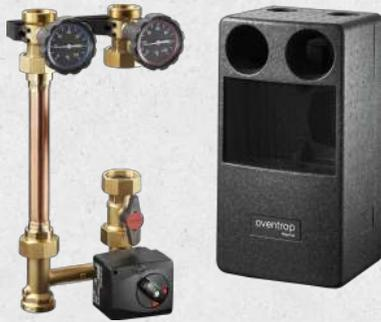
Für die Anbindung eines gemischten Heizkreises. Die Stationen beinhalten alle Armaturen, die für die Verbindung von Wärmeerzeuger, Pumpen und Rohrleitungen notwendig sind. Die Stationen ermöglichen das vor- und rücklaufseitige Absperrn des Heizkreises. Das Sperrventil im Rücklaufstrang verhindert Fehlzirkulationen. Vor- und Rücklauf können vor Ort individuell gewechselt werden.
