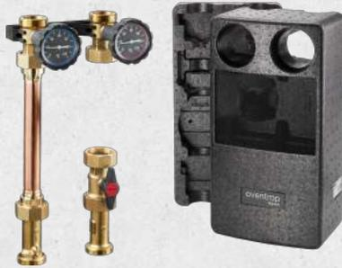
Für die Anbindung eines ungemischten Heizkreises. Die Stationen beinhalten alle Armaturen, die für die Verbindung von Wärmeerzeuger, Pumpen und Rohrleitungen notwendig sind. Die Stationen ermöglichen das vor- und rücklaufseitige Absperrn des Heizkreises. Das Sperrventil im Rücklaufstrang verhindert Fehlzirkulationen. Vor- und Rücklauf können vor Ort individuell gewechselt werden.
