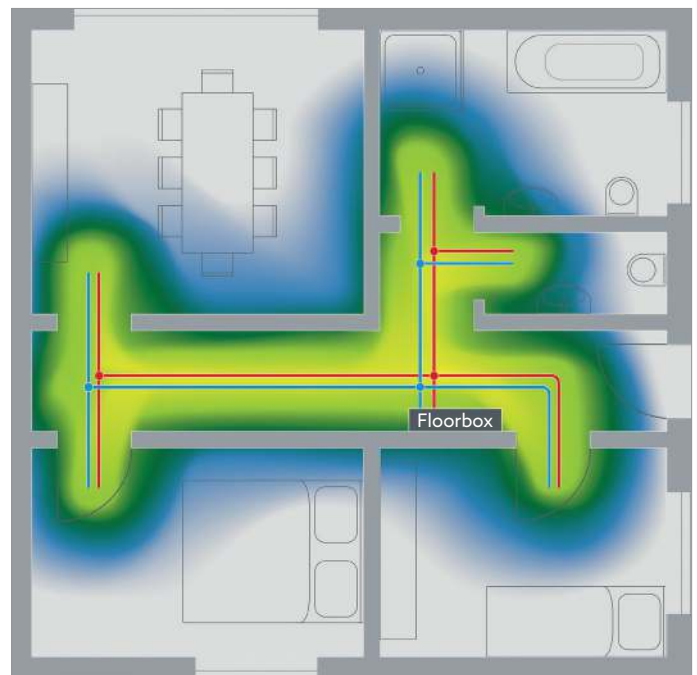
Unidis Flächenheizungssystem mit dezentraler Verteilung
