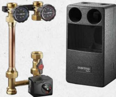
Für die Anbindung eines gemischten Heizkreises. Die Stationen beinhalten alle Armaturen, die für die Verbindung von Wärmeerzeuger, Pumpen und Rohrleitungen notwendig sind. Die Stationen ermöglichen das vor- und rücklaufseitige Absperren des Heizkreises. Das Sperrventil im Rücklaufstrang verhindert Fehlzirkulationen. Vor- und Rücklauf können vor Ort individuell gewechselt werden.
