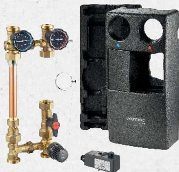
Für die Anbindung eines thermisch geregelten Heizkreises. Die Stationen dienen der Vorlauf-temperaturregelung und -begrenzung in kombinierten Radiator-Flächenheizungen. Sie beinhalten alle Armaturen, die für die Verbindung von Wärmeerzeuger, Pumpen und Rohrleitungen notwendig sind. Die Stationen ermöglichen das vor- und rücklaufseitige Absperrn des Heizkreises. Das Sperrventil im Rücklaufstrang verhindert Fehlzirkulationen.
