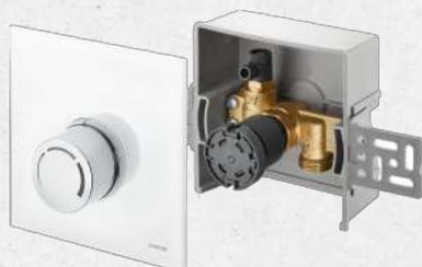
Die **Unibox** Rücklauftemperaturregelung dient zur Flächentemperierung von Räumen mit einer Größe von bis zu 20 m<sup>2</sup>, wie z.B. dem Badezimmer. Besonders eignen sich die Uniboxen zur Nachrüstung einer Flächentemperierung in Heizungsanlagen im kombinierten Einsatz mit Radiatoren. Die **Unibox** besteht aus dem Wandeinbaukasten mit Thermostatventil, dem integrierten Rücklauftemperaturbegrenzer, einem Entlüftungs- und Spülven-
