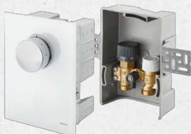
Die **Unibox** Raum- und Rücklauftemperaturregelung dient zur Flächentemperierung von Räumen mit einer Größe von bis zu 20 m<sup>2</sup>, wie z.B. dem Badezimmer. Besonders eignen sich die **Uniboxen** zur Nachrüstung einer Flächentemperierung in Heizungsanlagen im kombinierten Einsatz mit Radiatoren. Außerdem wird die **Unibox** auch zur Einzelraumtemperaturregelung verwendet. Die **Unibox** besteht aus dem Wandeinbaukasten mit voreinstellbarem Thermostatventil, dem integrierten
