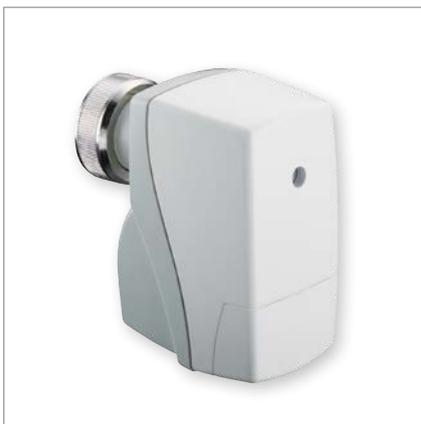
Elektromotorischer Stellantrieb mit Gewindeanschluss M 30 x 1,5. Zur Raumtemperaturregelung in Verbindung mit 3-Punkt-Reglern. Einsatz in Deckenstrahlheizungen, Deckenkühlsystemen und Induktionsgeräten.
