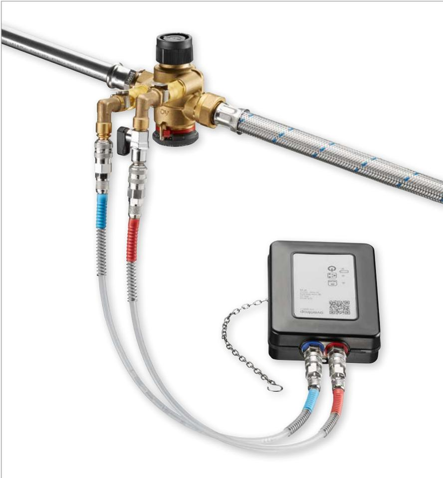
Mit einem Messgerät wie z.B. dem „OV-DMC3“ kann die Pumpeneinstellung optimiert werden. Dazu wird die Förderhöhe der Pumpe soweit reduziert, bis das „Cocon QTZ“ gerade noch im Regelbereich arbeitet.
