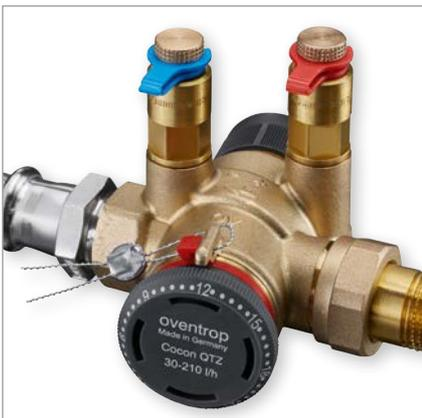
Die gewählte Einstellung kann durch Einrasten des Handrades und zusätzlich durch Aufclipsen des Blockierendes gesichert werden. Ein Plombieren ist möglich. Das „Cocon QTZ“ ist auch bei einem montiertem Stellantrieb ables- und einstellbar.
