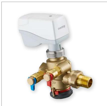
„Cocon QTZ“ mit elektromotorischem Stellantrieb für modulierende Regelung (0-10V) mit Gewindeanschluss M 30 x 1,5. Funktions- und Kennlinienauswahl mittels DIP-Schalteneinstellung. Einsatz in Zentralheizungs- und Kühlanlagen zur präzisen Durchfluss- und Temperaturregelung.
