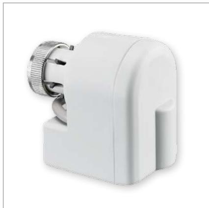
Elektromotorischer Stellantrieb mit Gewindeanschluss M 30 x 1,5. Zur Raumtemperaturregelung in Verbindung mit 2-Punkt-Reglern. Einsatz in Deckenstrahlheizungen, Deckenkühlsystemen und Induktionsgeräten.
