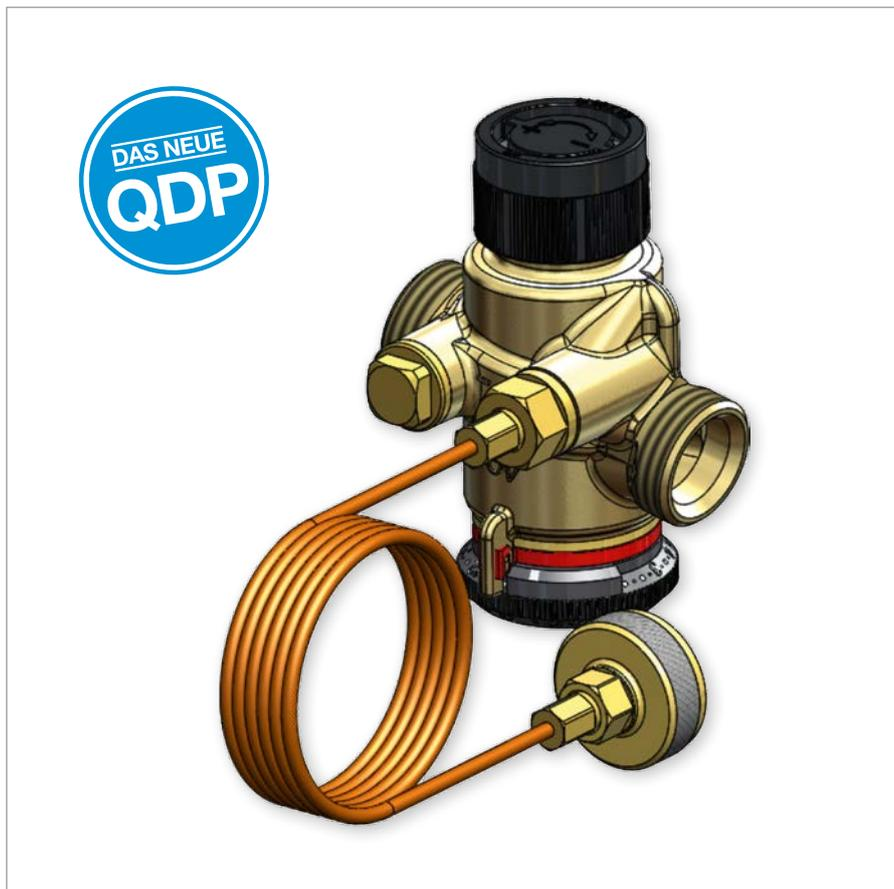
Das „Cocon QDP“ ermöglicht den automatischen hydraulischen Abgleich von Heizungs- und Kühlanlagen und hält den Differenzdruck konstant.
