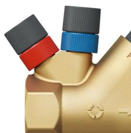
Jedes HydroControl M ist standardmäßig mit zwei HydroPort Hilfsventilen ausgestattet. Mit HydroPort lässt sich Zubehör einfach und sicher per Schnappverschluss anschließen. HydroPort Ventile werden durch eine kurze Drehung geöffnet. Zur Druckabnahme reicht eine Vierteldrehung, zum Entleeren und Füllen reicht eine volle Umdrehung.
