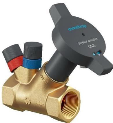
Strangregulierventil für den statischen hydraulischen Abgleich von Rohrnetzen in geschlossenen Heizungs- und Kühlwasseranlagen. Es bietet eine Messfunktion über eine feste Messblende was gleichzeitiges Messen und Einstellen ermöglicht.
